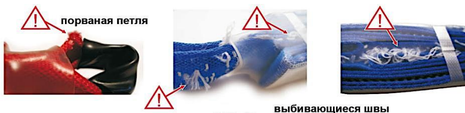
Рис. 26 Требования к целостности анкерной петли и видимых швов стропа
