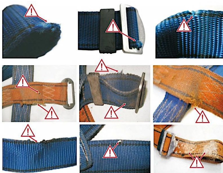
Рис. 22 Повреждения при которых запрещена эксплуатация
