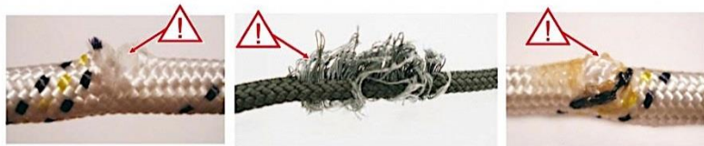
Рис. 18 Отбраковка строп для позиционирования
