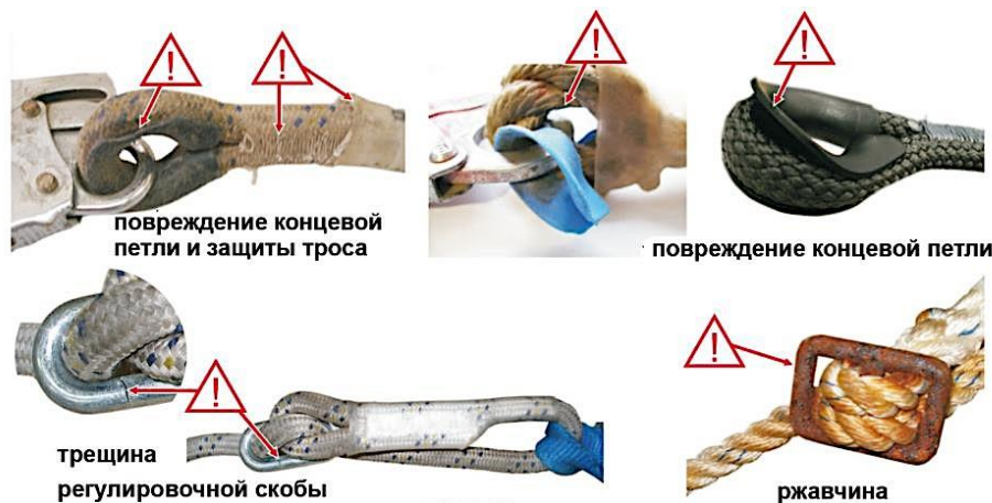
Рис. 33 Выбравка регулировочной петли
