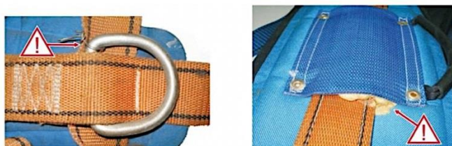
Рис. 21 Признаки модернизации, ремонта, некомплектности
