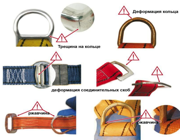
Рис. 24 Дефекты и повреждения при которых эксплуатация запрещена
