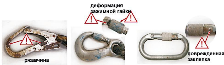
Рис. 36 Выбраковка соединителей
