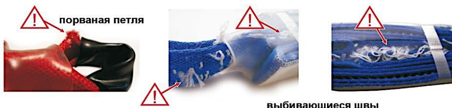
Рис. 31 Требования к целостности амортизаторной петли и видимых швов стропа
