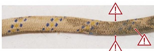
Рис. 28 Требования к целостности основного полотна стропа
