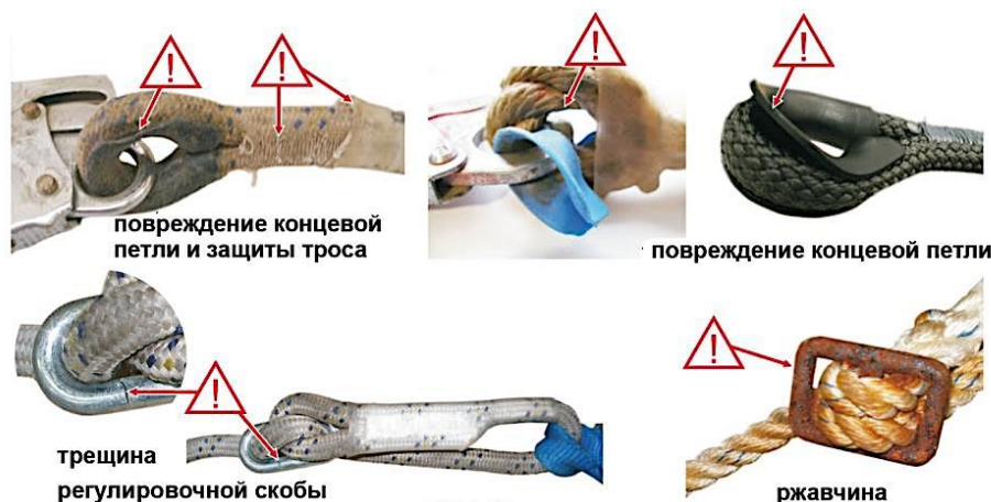
Рис. 41 Анкерные петли, швы, стыки и концевые петли линии, подлежащие проверке
