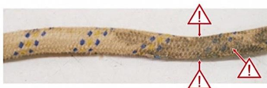
Рис. 19 Химическое повреждение стропов
