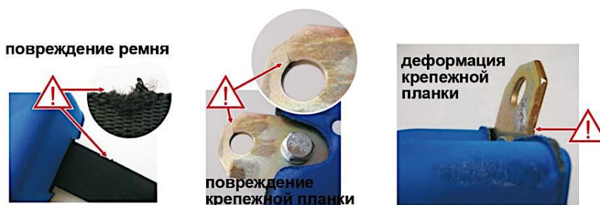
Рис. 43 Выбраковка блокирующих устройств
