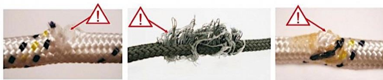
Рис. 27 Требования к целостности основного полотна стропа
