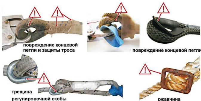
Рис. 20 Отбраковка регулирующих скоб позиционирующего стропа
