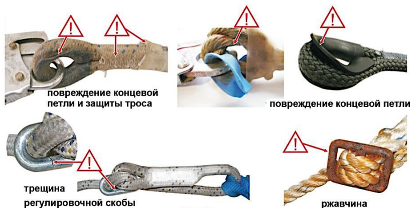
Рис. 29 Выбраковка регулировочной петли
