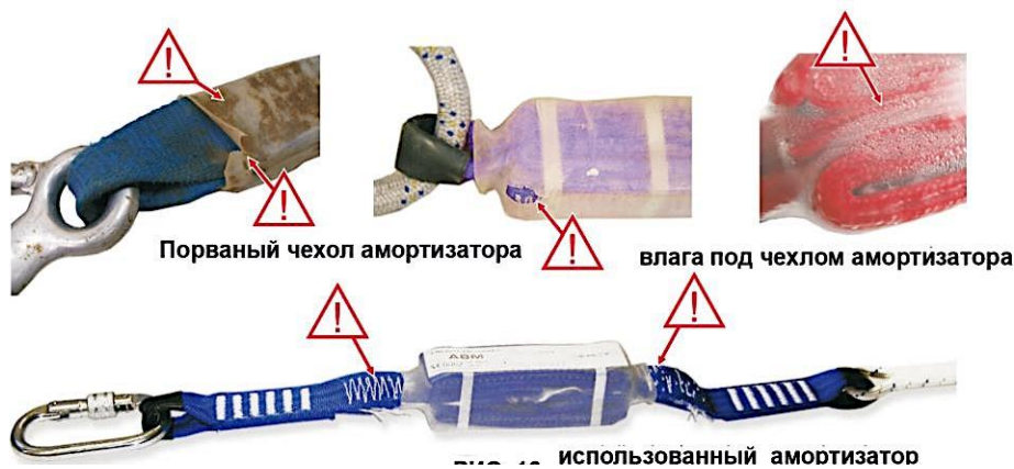
Рис. 45 Проверка на химическое или термическое повреждение
