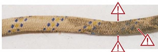
Рис. 40 Признаки химического повреждения
